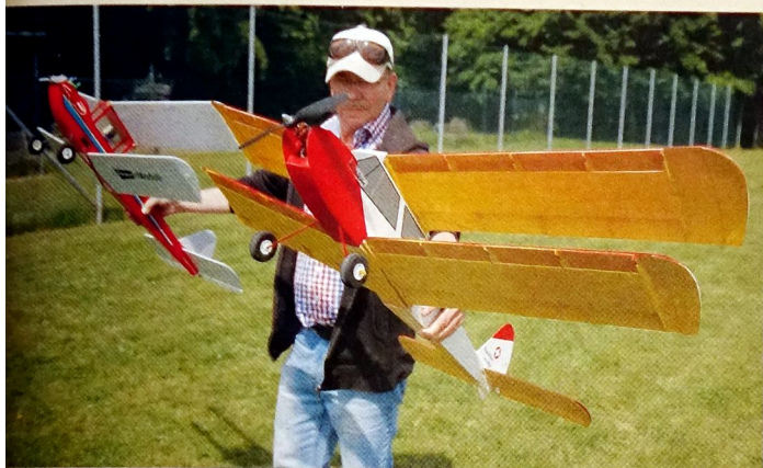
Rechts die Jedelsky-ähnliche Tragfläche, links die Rippenfläche
