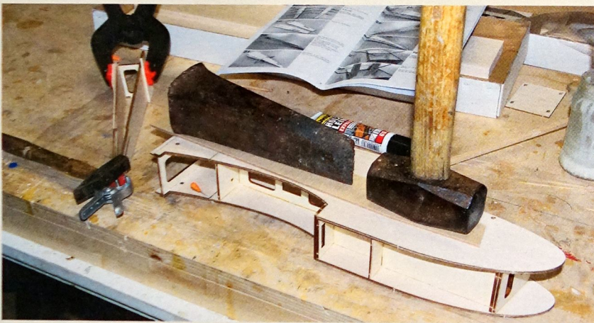
Das Vorderteil des Rumpfes in der Weißleimtrockenphase. Bei gelaserten Bauteilen ist Sekundenkleber an der „Brennstelle“ weitgehend ineffektiv!
