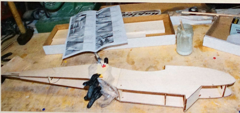
Vorder- und Hinterteil des Rumpfes klebt man zusammen
